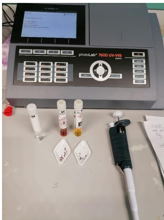
Figura 21. Spettrofotometro IWR multi-parametro e fiale predosate per analisi COD (Chemical Oxygen Demand).
