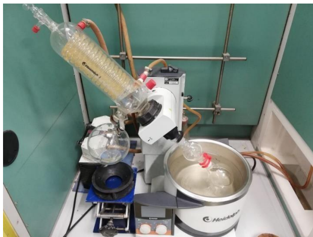
Figura 18. Concentrazione dell'estratto utilizzando l'evaporatore rotante.
