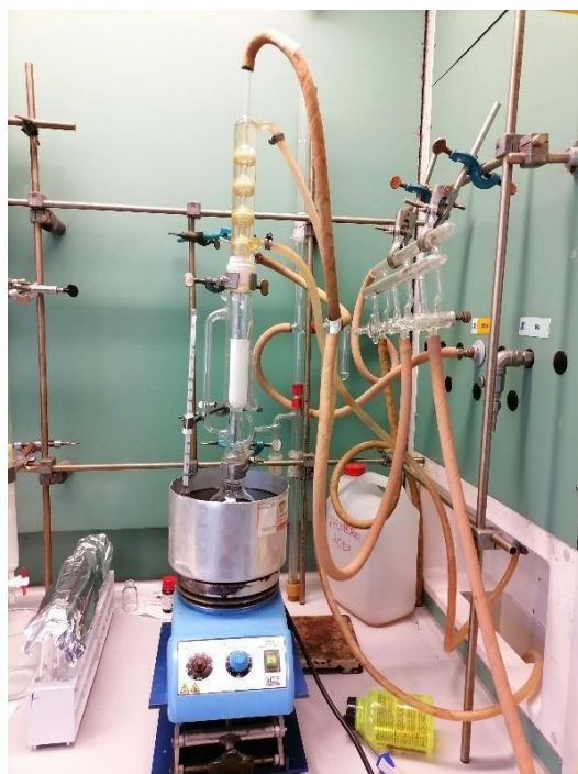
Figura 17. Estrazione di lipidi mediante metodo Soxhlet in atmosfera controllata.
