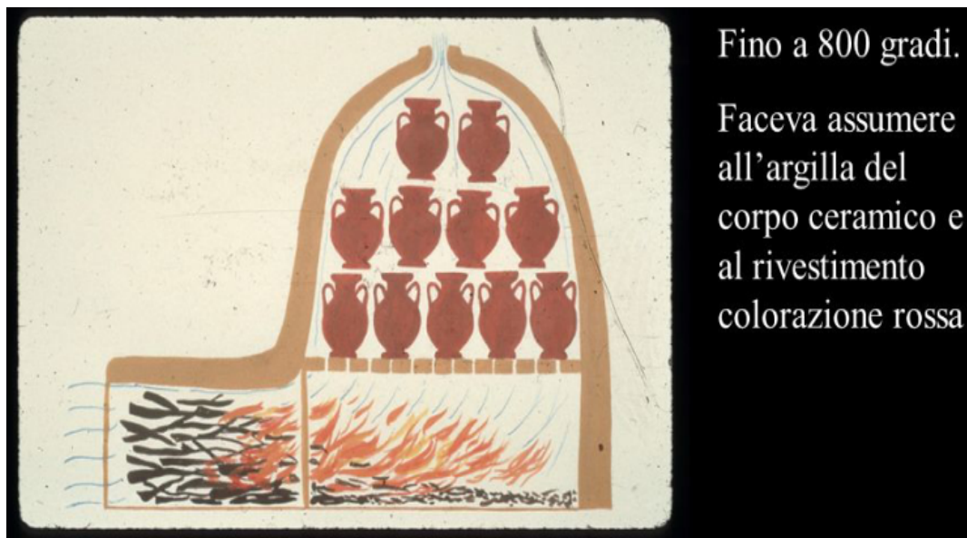
Fig 51: schema di una fornace dell'età classica per la cottura di anfore colorate
