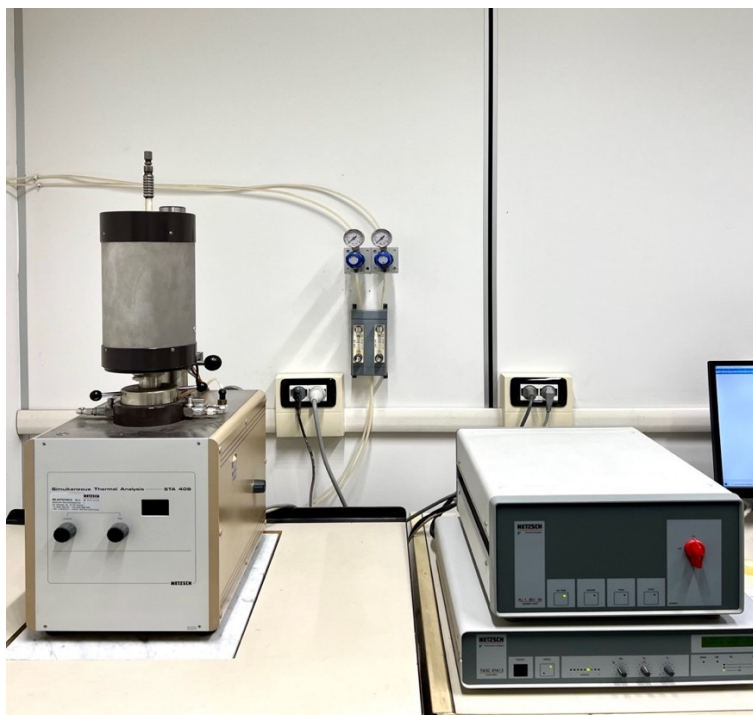
Fig.4.5: Apparato sperimentale per analisi termogravimetrica Netzsch STA 409
