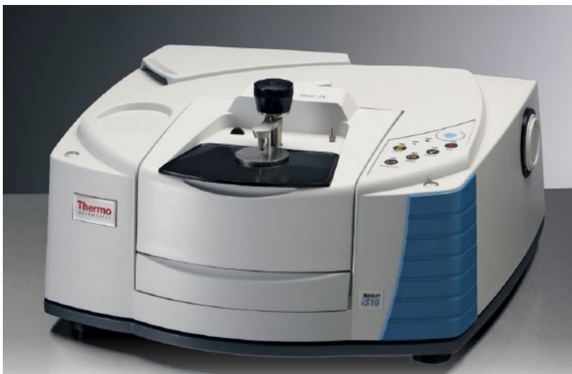
Fig. 4.2: Thermo Scientific Nicolet iS10 Spettrometro FT-IR con accessorio Smart iTX.
