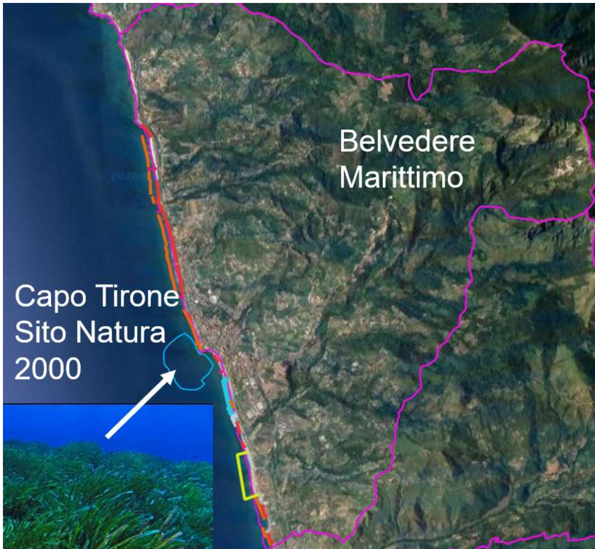
Figura 3-4. La linea di costa di Belvedere Marittimo nel 2022. In fucsia i limiti comunali, in arancione le barriere di massi distaccate; in rosso le barriere radenti; in azzurro il porto, in giallo la barriera sottomarina di Calabaia. (Da Maiolo et al. 2020b )
