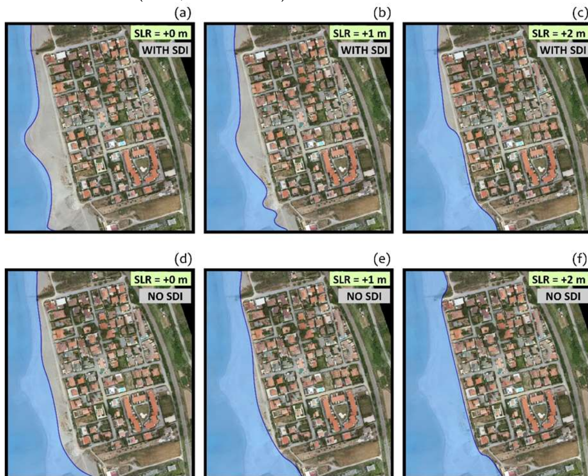
Figura 8-11. Evento del 28 dicembre 1999, 22 CET. Mappe di inondazione della spiaggia di Calabaia in diversi scenari di SLR (+ 0 m (a, d), +1 m (b, e) e + 2 m (c, f)). I pannelli (a) - (c) si riferiscono alla condizione attuale con l'intervento di difesa dal mare (WITH SDI), i pannelli (d) - (f) allo scenario morfologico precedente (cioè, pre-2006), senza alcun intervento (NO SDI). (Da Mel. et al. 2022)
