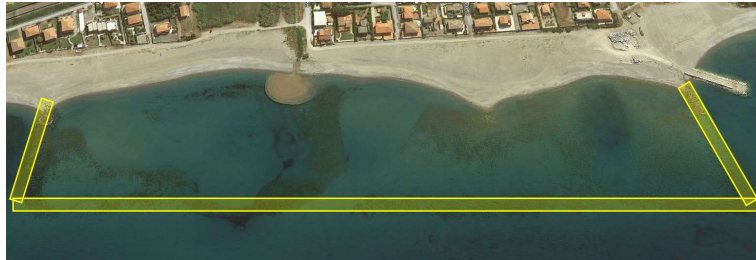
Figura 3-6 – Spiaggia di Calabaia nel 2022, a sud della costa di Belvedere Marittimo. In giallo è evidenziata la presenza della barriera soffolta. (Da Maiolo et al. 2020b)
