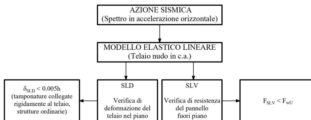
Figura 2.9 – Attuali verifiche SLD e SLV per le tamponature secondo le NTC18 ed EC8.
