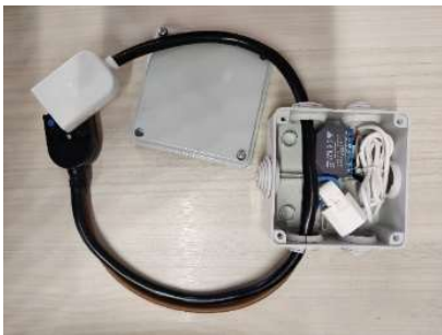
Figura 5.26 Sistema di protezione e alimentazione realizzato per i misuratori
