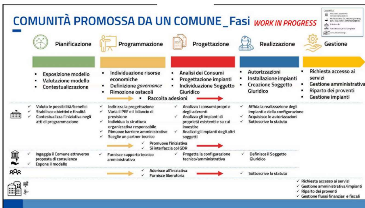
Figura 1.2 Fasi del processo di realizzazione di una comunità energetica. fonte: GSE in-FORMA PA
